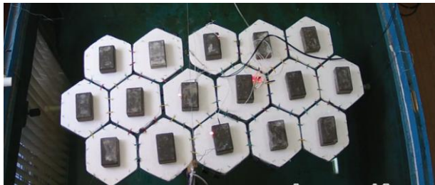
Рисунок 12 - Сотовая конструкция из связанных моделей понтонов в опытном бассейне СевГУ
