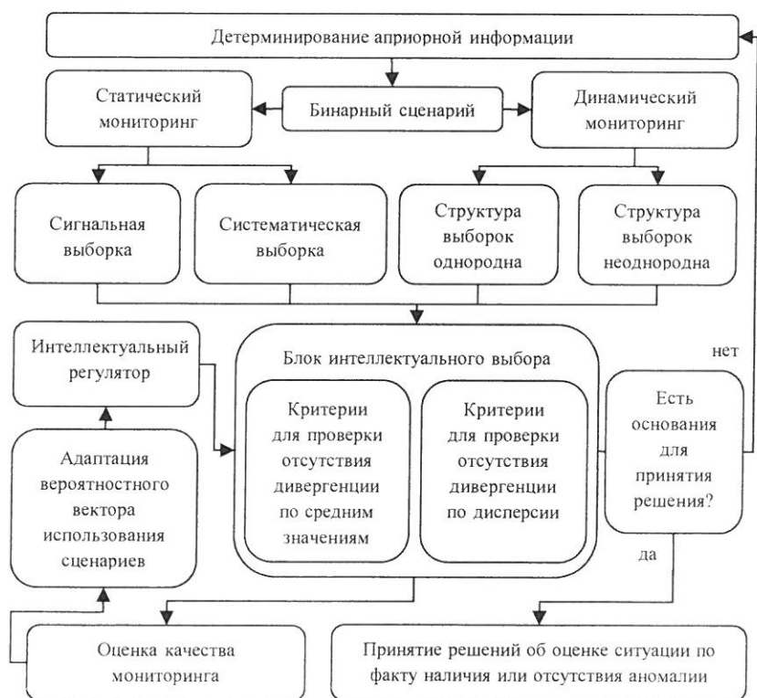
Рисунок 2 – Структура конфигурируемого комплекса выбора критерия обнаружения аномалий в данных мониторинговых наблюдений природной среды
