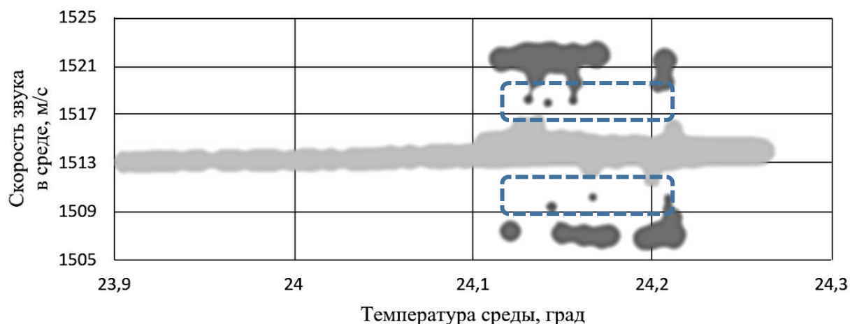
Рисунок 3.8. Результирующая диаграмма управляющей матрицы бинарного классификатора, где темно-серым пятном обозначены области, данные в которых признаются аномальными, светло-серым пятном – истинные данные, пунктиром – зона неопределенности
