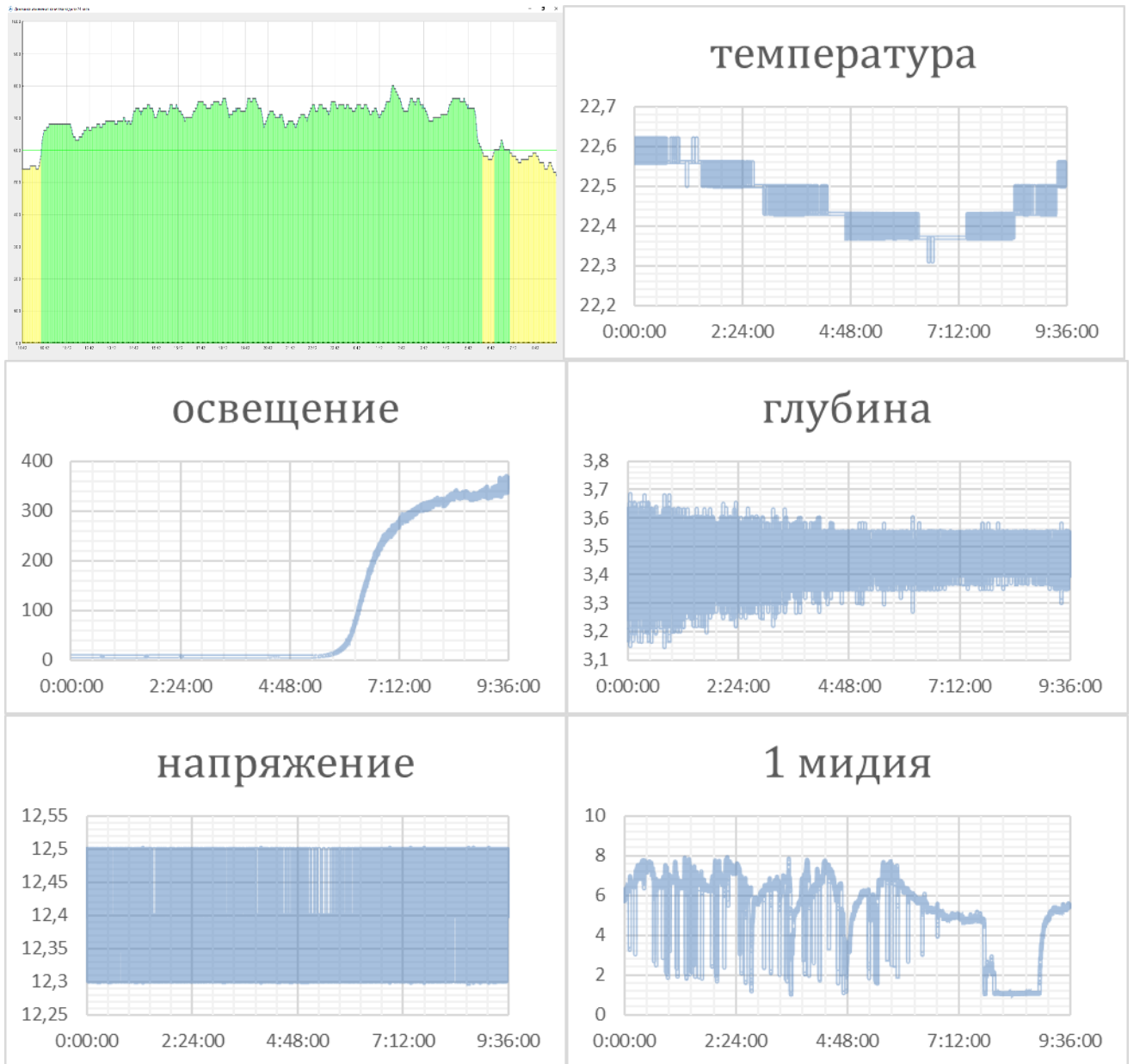
Рисунок 4.10. Визуальное представление на графическом интерфейсе интегрального показателя состояния ПС и отдельных его компонентов распределенные во времени
