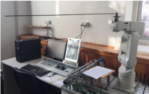
Рис.17 – Экспериментальный стенд для исследования вращения стержня
