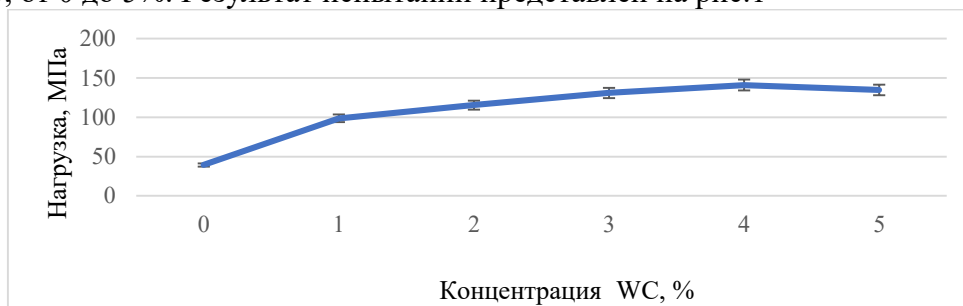
Рисунок 1 – Изменение предела прочности на разрыв.
