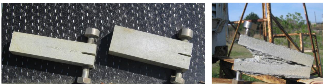
Рисунок 1 – Внешний вид образцов сплавов В-95Т2 (а), 1420 (б) после 10 лет, а 1161Т (в) после 7 лет экспозиции в морской атмосфере влажных субтропиков
