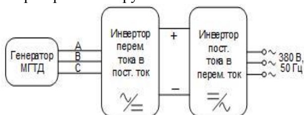
Рисунок 1 – Функциональная схема силового электронного преобразователя
